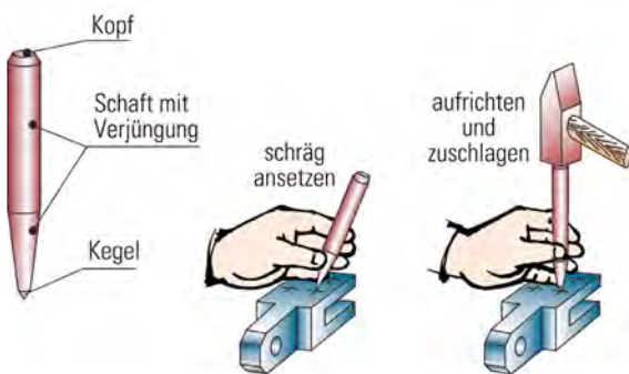
2 Bohrungsmittelpunkt ankörnen
