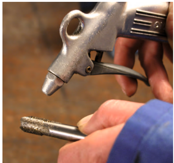
2 Säubern von Spannuten mit Druckluft
