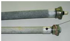
die Opferanode im Warmwasserspeicher sacrificial anode from a hot-water tank أنود ذوّاب في خزان مياه ساخنة آند تخريبي در مخزن آب گرم
